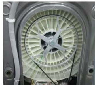
优化后的铸铝材料4辐皮带轮现在已批量生产
