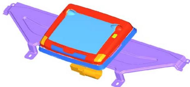
图 1 吸顶屏装置有限元模型
