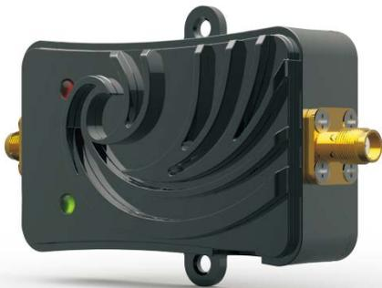
本产品是专为 5.8GHz 频段开发，IEEE802.11 n/ac 标准的双向功率放大器。该产品与直接序列（DSSS）、正交频分复用（OFDM）等频率扩展技术相匹配。采用 Time Division Duplex（TDD）快速微波检测技术和线性功放技术，在保证 802.11 n/ac 无线设备传输速率不变的情况下，极大扩展无线射频通讯距离。
