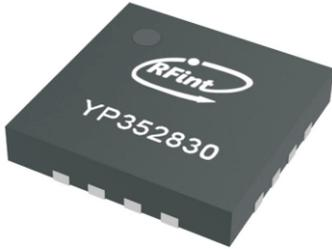
该射频功率放大器芯片，采用了多项英诺迅科技自主专利技术及先进的InGaP/GaAs HBT工艺制程，具有较高的增益及线性度；芯片内部集成了ESD保护单元，具有较高的可靠性。芯片采用QFN封装，尺寸为4mm×4mm，易于系统集成及小型化。
