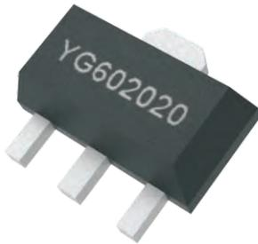
该宽带射频增益放大器芯片，采用了多项英诺迅科技自主专利技术及先进的InGaP/GaAs HBT工艺制程，内部集成有源偏置电路，输入输出匹配至50欧姆，易于系统集成应用。芯片采用符合工业标准的SOT-89封装，内部集成ESD保护单元，具有较高的可靠性。
