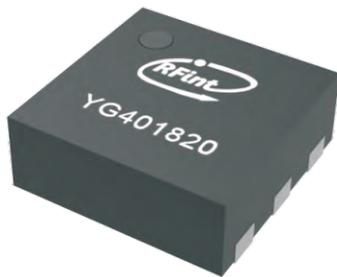
该宽带射频增益放大器芯片，采用了多项英诺迅科技自主专利技术及先进的InGaP/GaAs HBT工艺制程，内部集成有源偏置电路，输入输出匹配至50欧姆，易于系统集成应用。芯片采用符合工业标准的DFN封装，内部集成ESD保护单元，具有较高的可靠性。
