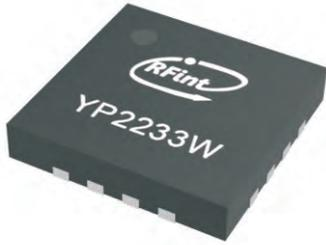
该宽带射频功率放大器芯片，采用了多项英诺迅科技自主专利技术及先进的InGaP/GaAs HBT工艺制程；芯片内部集成了ESD保护单元，具有较高的可靠性。芯片采用QFN封装，尺寸为4mm×4mm，易于系统集成及小型化。
