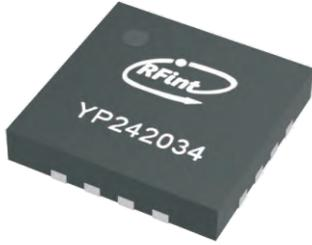
该射频功率放大器芯片，采用了多项英诺迅科技自主专利技术及先进的InGaP/GaAs HBT工艺制程，具有较高的增益及线性度；芯片内部集成了ESD保护单元，具有较高的可靠性。芯片采用QFN封装，尺寸为4mm×4mm，易于系统集成及小型化。
