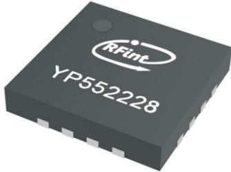
该宽带射频功率放大器芯片，采用了多项英诺迅科技自主专利技术及先进的InGaP/GaAs HBT工艺制程，具有较高的输出功率和效率；芯片内部集成了ESD保护单元，具有较高的可靠性。芯片采用QFN封装，尺寸为4mm×4mm，易于系统集成及小型化。
