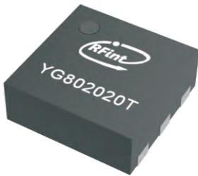
该宽带射频增益放大器芯片，采用了多项英诺迅科技自主专利技术及先进的InGaP/GaAs HBT工艺制程，采用级联电路架构，内部集成有源偏置电路，提高电路线性度，实现温度补偿。芯片采用符合工业标准的DFN封装，内部ESD和VSWR保护单元，具有高可靠性。
