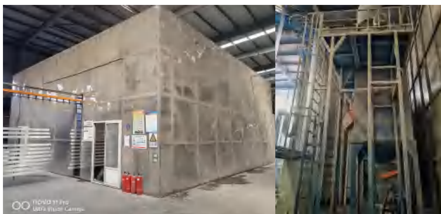
密闭喷涂房+自带袋式过滤
