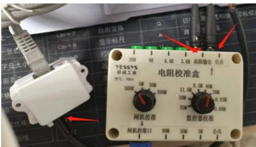
接线方式：两芯线，一头接公共端，一头接高阻输出端。
