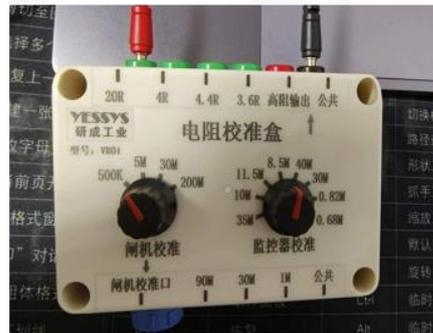
设备通道校准：按照图片黑线一头接电阻箱公共端，另外一头接工位监控器主地线，红线一头接 4 欧姆输出接口根据校准步骤切换到第二步接 20 欧姆，一头接被校准通道端螺丝。
