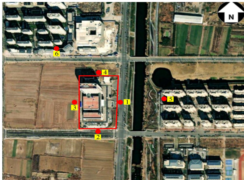
图 5-1 DSA 机房周围辐射环境验收监测布点示意图
