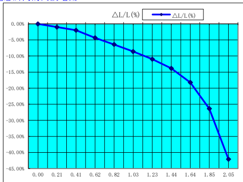
Isat(飽和電流):電感瞬間的突波電流
