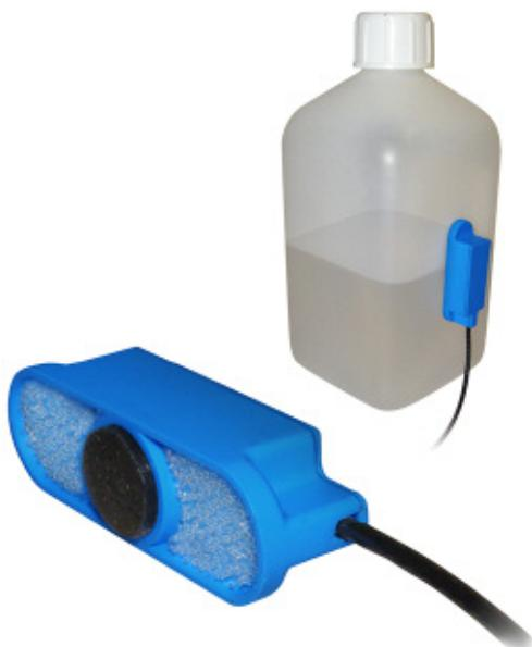
Introtek液位传感器是一个极为简单使用的小型化传感器。电路板已搭配在传感器里面也不需要任何的校正。PLD是最先进的非侵入性、脉冲式超声传感器可精准的、可靠性高、重复性的侦测液位高度。
