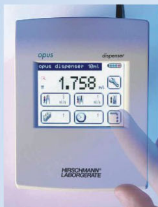
10ml 规格可实现小数点后三位精度，精确到 1ul 的分液。
