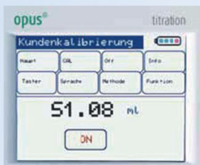
Quick-cal 校准只需按入数值就可自动完成，直接测量，使校准不再麻烦。
