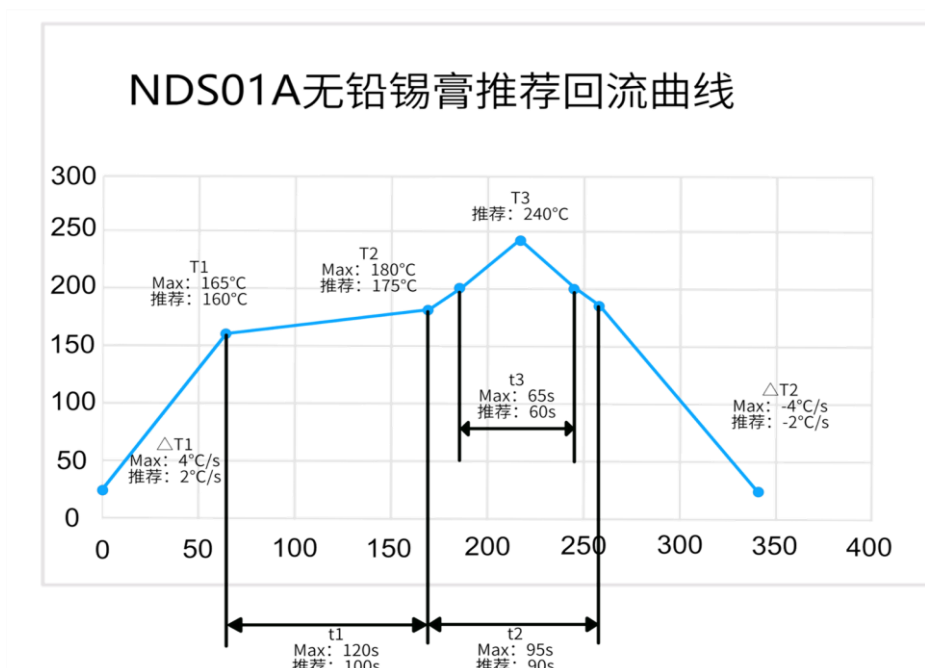
图 10-1 NDS01A 无铅锡膏推荐回流曲线
