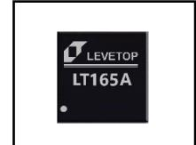
LT165A 内部的主频可达 150MHz，含有 32KB SRAM，除了提供串口通讯，也提供一个 QSPI Flash 接口，用来快速读取储存在外部 SPI Flash 的程序代码、图片、动画等信息，LT165A 可以配合研发的串口屏开发软件 (UI\_Editor)、模拟软件 (UI\_Emulator)，直接在电脑上进行产品的 UI 显示界面开发，其所支持的显示功能包括图片显示、GIF 动画显示、循环图片显示、进度条显示、显示、文字符串显示、PWM(DMA 模式) 音讯播放，及结合触控功能的多变量控制显示，除了提升显示效率外，也大幅缩短 TFT 显示的开发周期。此外，LT165A 还提供另一组的 SCI (Uart) 接口可以连接如蓝牙模块或 WiFi 模块，也有包括 CanBus、模拟输入 AIN、PWM 及 INT 中断等接口，还有电容触控输入接口，这些也可设置成普通 IO 接口，同时自带 RTC 时钟，丰富的功能增加了串口屏的实用与适用范围，芯片特性符合车规标准设计与应用。LT165A 可以支持双屏显示、或是并屏显示的应用，具有良好的流畅度与极高的性价比。
