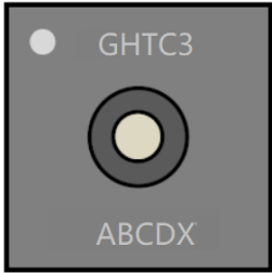
图 8 GXHTC3 正面激光标识
