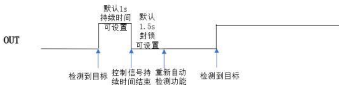
图 4.2 检测目标：OUT 引脚输出信号时序图
