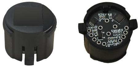
ATT01 是一款自带热追踪功能，用于高速电吹风产品的 AI 感知模块，该模块具有红外非接触测温传感器和 ToF 测距传感器，可以直接测头发的温度、传感器所在环境的环境温度以及电吹风与头发的距离。模块可通过 UART 串口通信接口，将头发实时温度和电吹风与头发距离的数据传输给电吹风的主控单元，配合领麦微专用算法实现恒温吹发、无级变速、动态跟随等全新体验。
