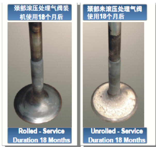
图 6 滚压处理气阀使用对比图
