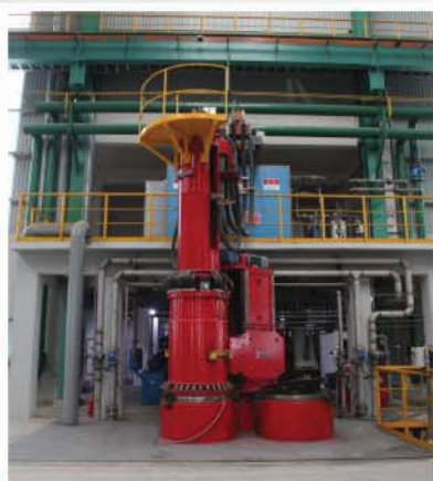
12吨真空自耗炉
