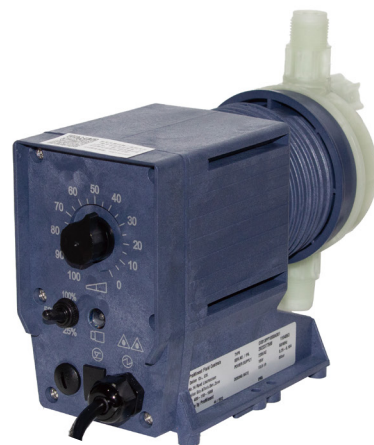
型号: Concept C电磁驱动计量泵 流量范围: 0.72-24 l/h, 背压: 16-1.5 bar
