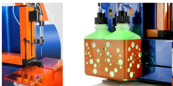
图 5：左图为机械臂上样，右图为溶液瓶发光颜色提示仪器状态。
