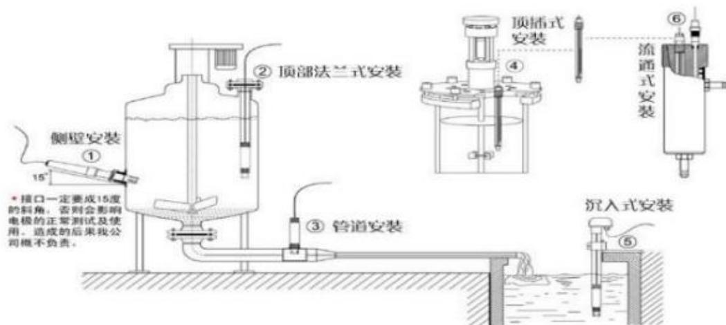
注意：传感器安装时不能倒置或水平安装，至少倾斜15度角以上安装。
