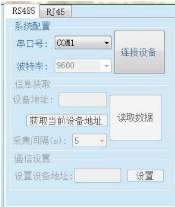
设备连接后，【信息获取】中设备地址加载完成；【传感器类型选择】中，默认勾选当前面板中设置的功能；【实时数据】中显示勾选的功能列表。如图。
