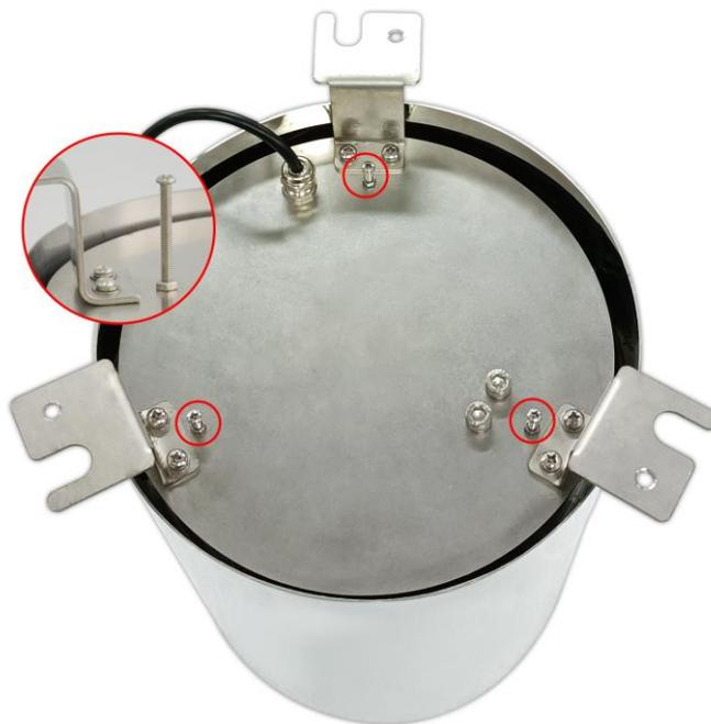
蒸发传感器设置在露天空旷平坦地方，并能终日受到阳光照射，调好水平，底座用水泥固定好，观测前加水至溢出为止（此时水深 200mm），如容器内有雨水降入时，应在观测记录时减去降雨量得出该次实际蒸发量，在进行数据计算时，由于蒸发量会减小，所以应加上该次降雨量。
