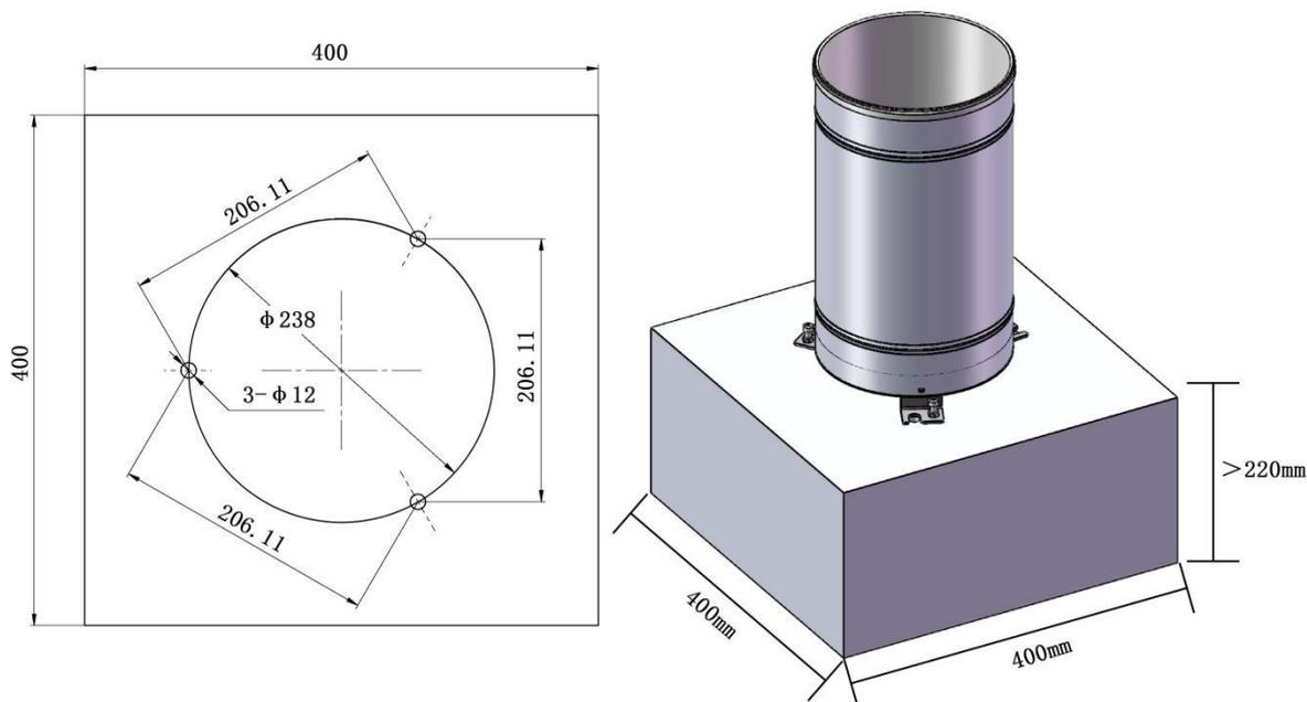
室外地面或屋顶安装时，应先制作水泥台。水泥台露出地平面高度为 22cm，尺寸为：长 40cm×宽 40cm，其上平面为水平面。地面安装时，承雨口高度距地平
