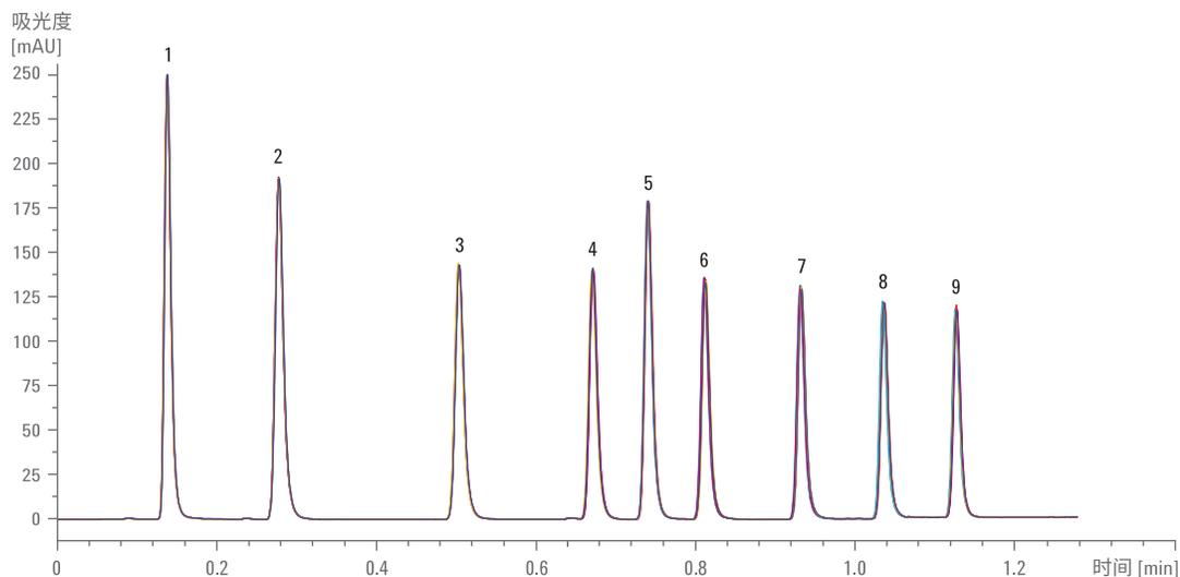
使用 Poroshell 120 EC-18, 3 × 50 mm, 2.7 μm 色谱柱以 1 μL 进样量对标准样品进行 6 次连续分析所得叠加色谱图，显示了 563 bar 下快速梯度运行的保留时间精密度小于 0.15% RSD
