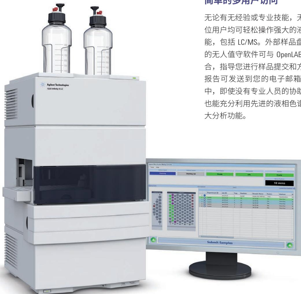
优化的无人值守解决方案有助于在多用户环境中实现简单、轻松的液相色谱和液质联用分析。无人值守软件使样品提交更为轻松，只需登录、选择方法然后将样品瓶放置到指定位置即可
