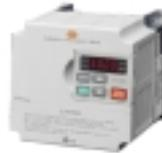
LG变频器出厂最大频率设定为60Hz，把它改为100Hz，电位计运行时I/O组的VT最大电压对应的频率设定为100Hz。
