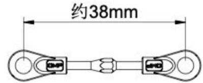
※ 制作两根长度一样的连杆，连接时，尖端朝下；球头座有logo面朝外，另一面与球头螺丝连接。连杆有正反螺纹，无需将连杆从直升机上取下，即可调整螺丝扣的长度。
