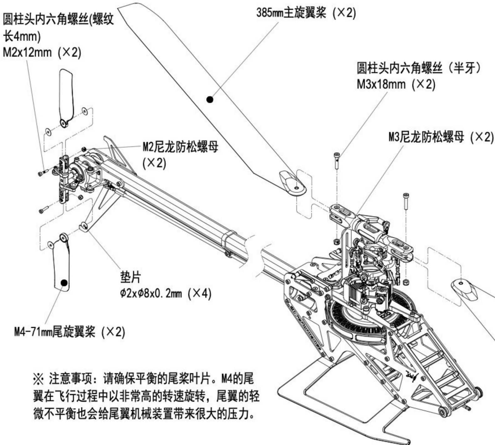
※ 注意事项：请确保平衡的尾桨叶片。M4的尾翼在飞行过程中以非常高的转速旋转，尾翼的轻微不平衡也会给尾翼机械装置带来很大的压力。
