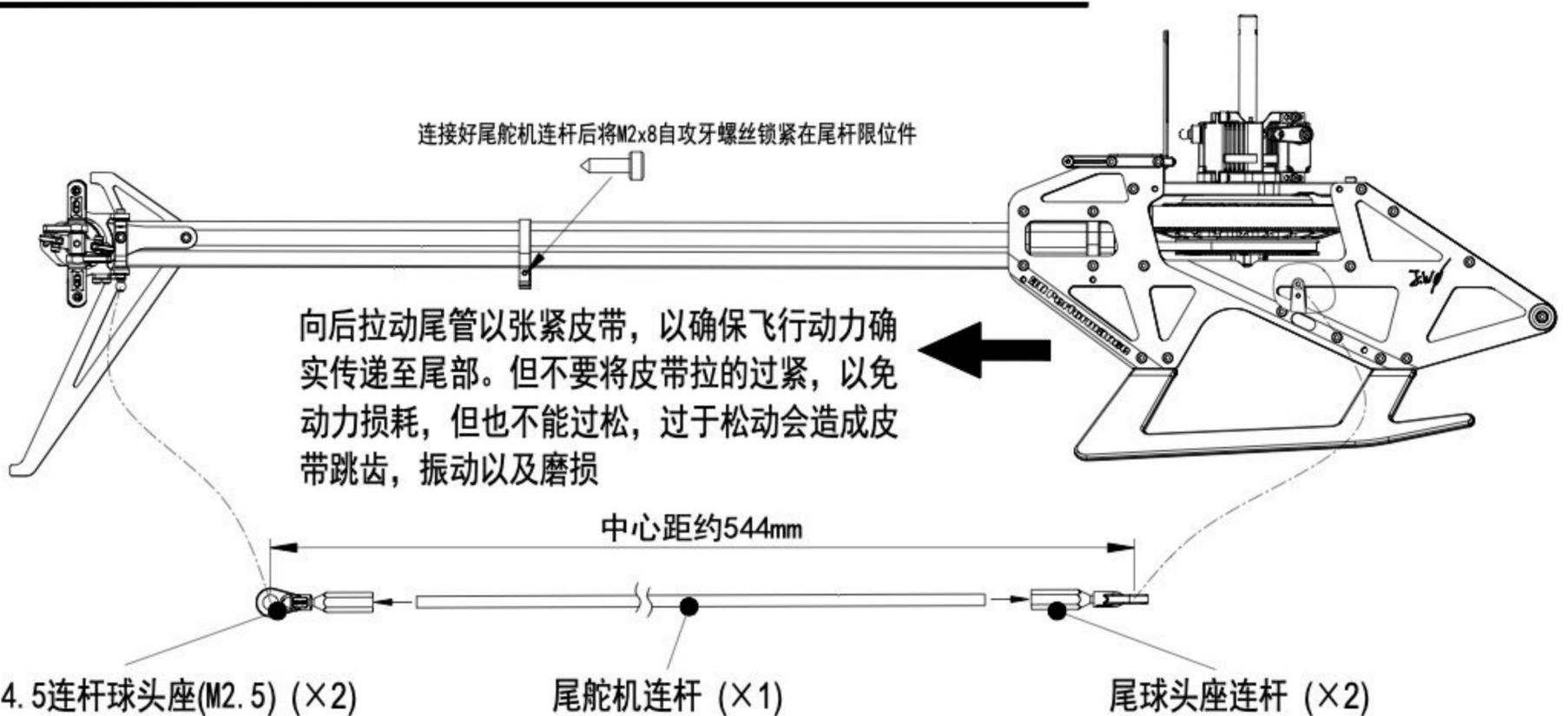
连接好尾舵机连杆后将M2x8自攻牙螺丝锁紧在尾杆限位件
