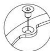
※ 主滑轮法兰碳片区分正反面, 安装时应与沉头螺丝相嵌合。
