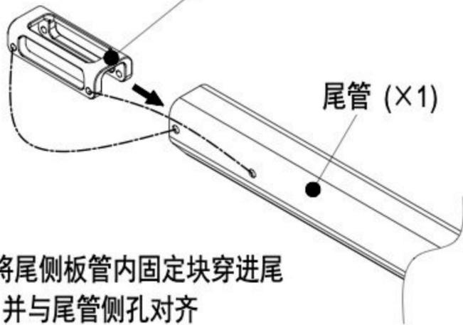
※ 先将尾侧板管内固定块穿进尾管内，并与尾管侧孔对齐
