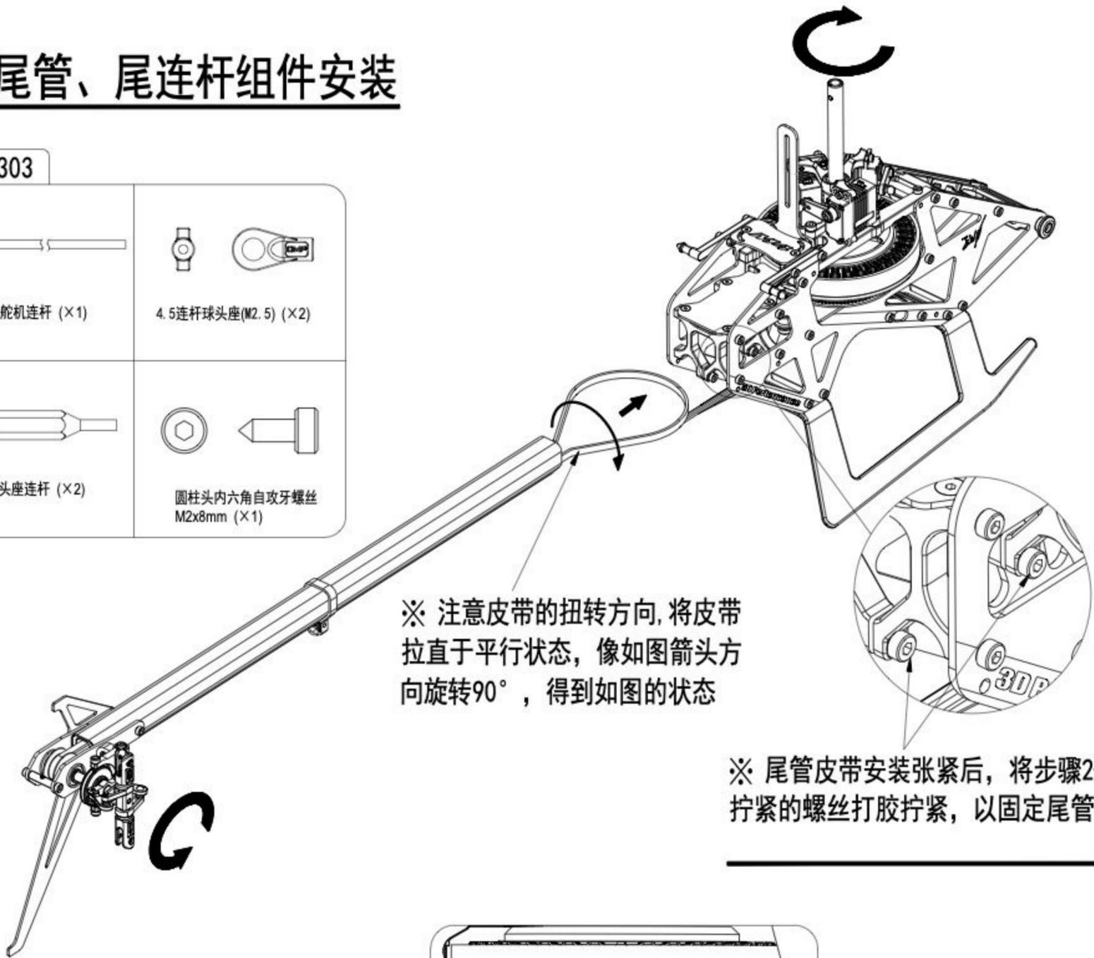
※ 注意皮带的扭转方向, 将皮带拉直于平行状态, 像如图箭头方向旋转90°, 得到如图的状态
