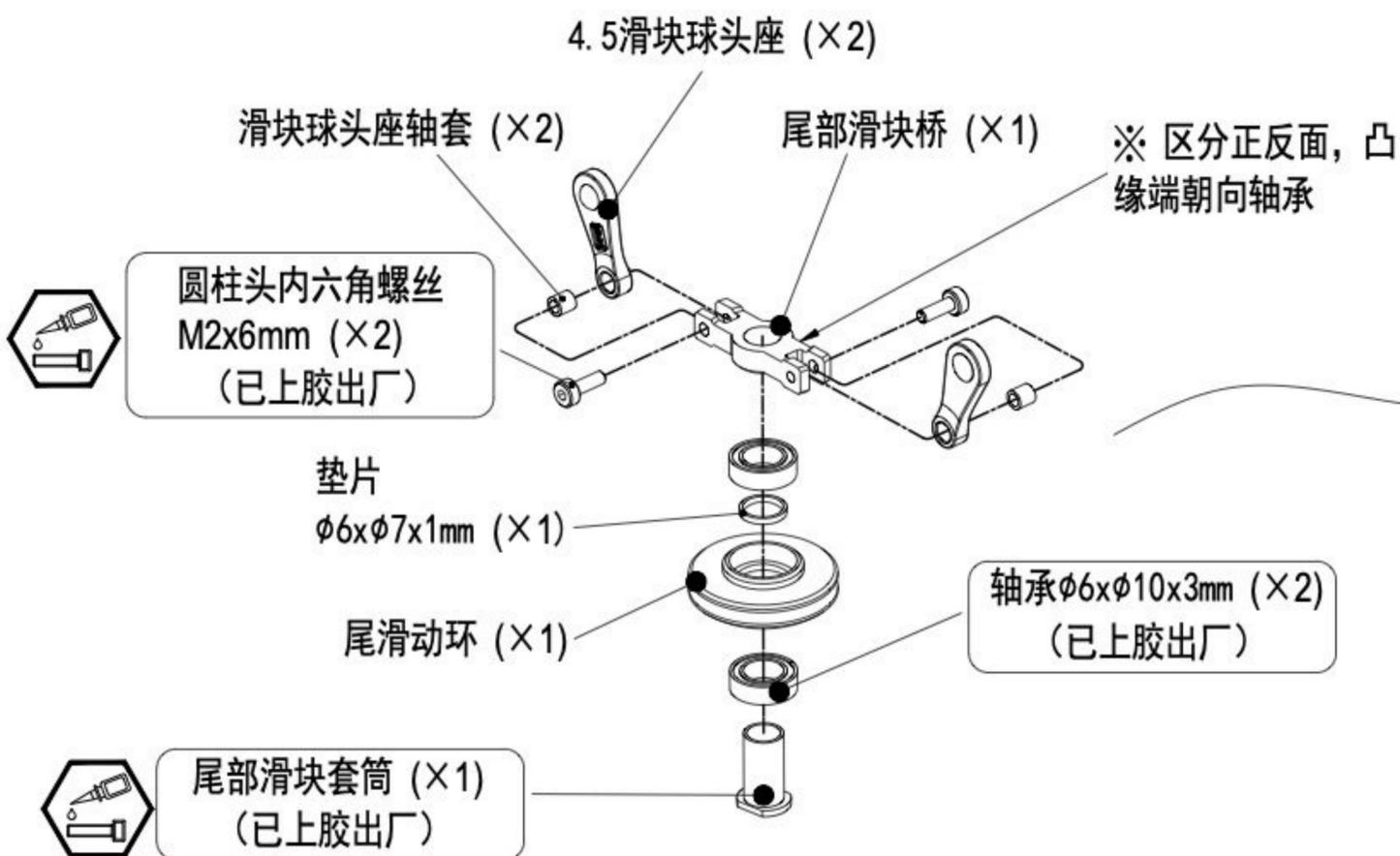
※ 此组件出厂前已打好螺丝胶, 无需拆卸重新安装
