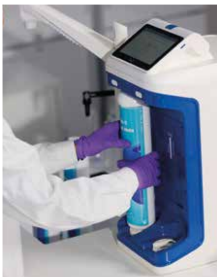
纯化柱的旋转锁紧设计特点使耗材更换轻松便捷。
