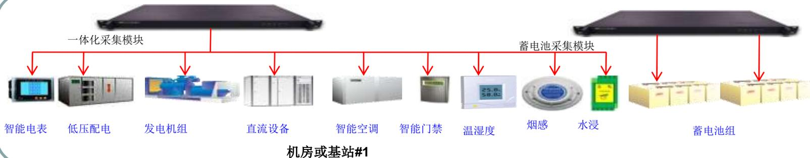
系统采用树状阶层分布式网络拓扑，最适合电力和通信机房数量多、分布广、设备类型复杂的监控要求。分布式组网架构设计使实时数据的采集与处理不受建设规模的影响。
