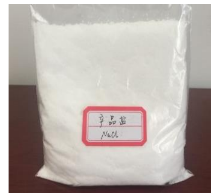
电渗析浓水蒸发结晶氯化钠产品
