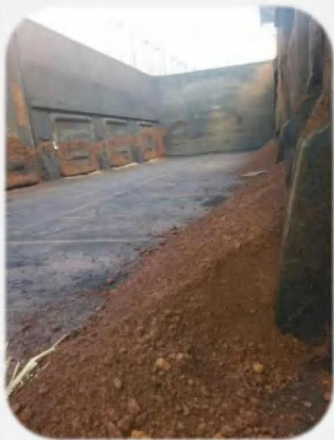
车厢角落残留
