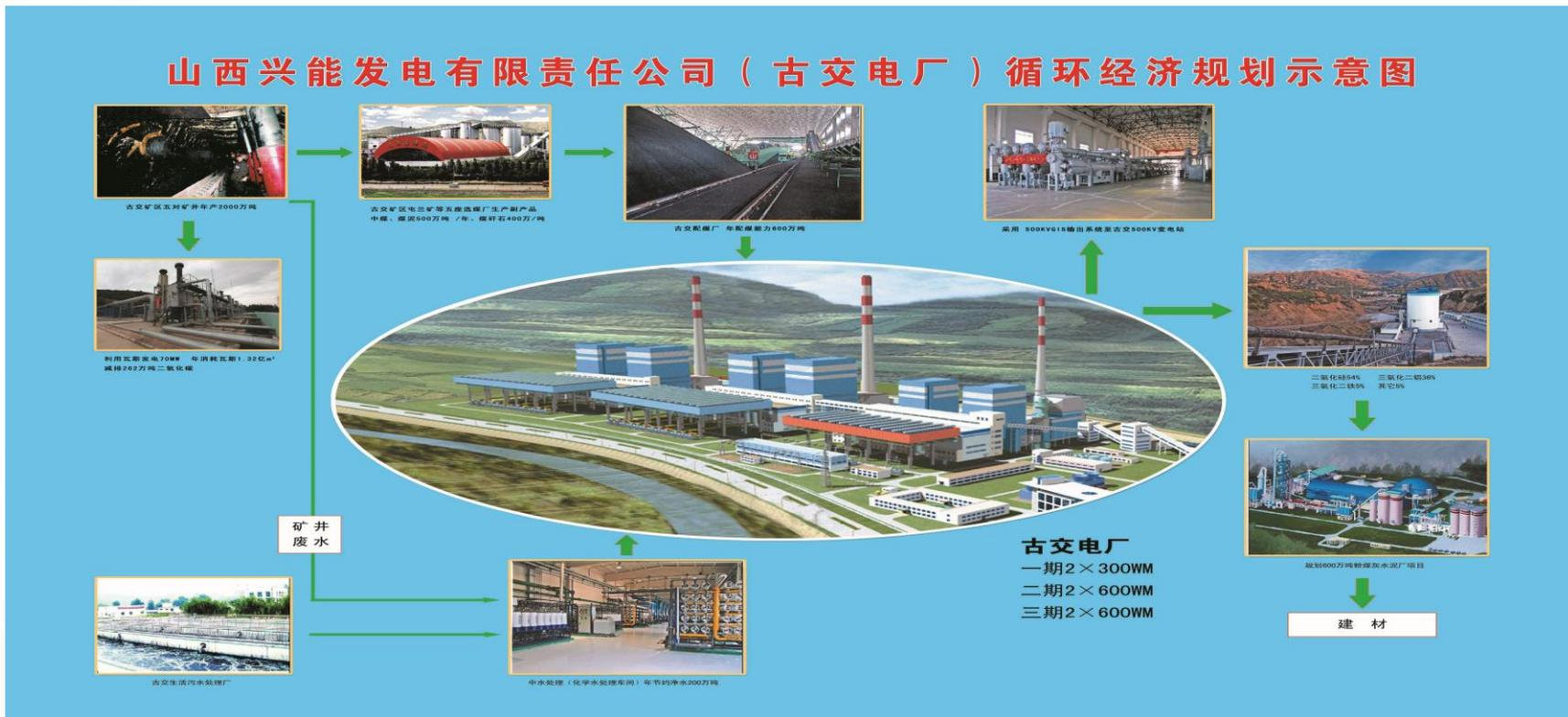
如图所示：古交矿区五对矿井生产的原煤→五座选煤厂生产的精煤外销后剩余的洗煤副产品中煤→古交电厂发电→发电后产生的副产品泛气、粉煤灰、石膏等→城市供热、建材厂生产水泥、纸面石膏板等产品，形成了“煤-电-热-建材”循环经济产业链。
