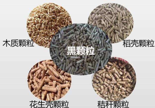
**黑颗粒与白颗粒相比优势：**黑颗粒压制成型增加特殊工艺处理，去除生物质原料K、Na、Cl、N、S等对锅炉燃烧不利的元素，减少积灰，提高灰熔点、提高热值、便于存储、不亲水、易破碎，具备了不改变锅炉即可完全取代燃煤锅炉的能力。
