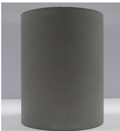
2. 基础材料：锅炉钢（20G），在钢材表面进行 Sa2.5 级别喷砂，喷涂热超导陶瓷涂层-A，如上图。
