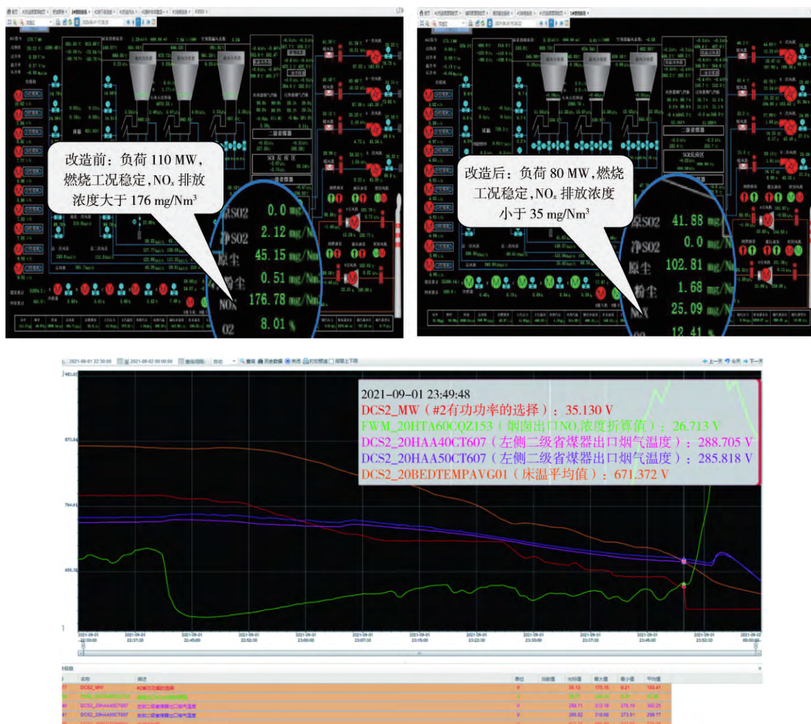
图3 2 # 炉改造前、后燃烧工况画面图
