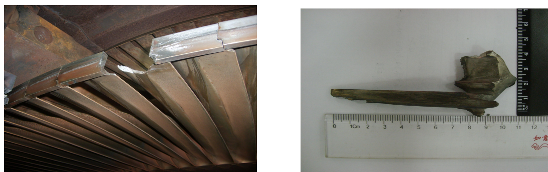
图一 叶片断裂处及断裂的叶片
