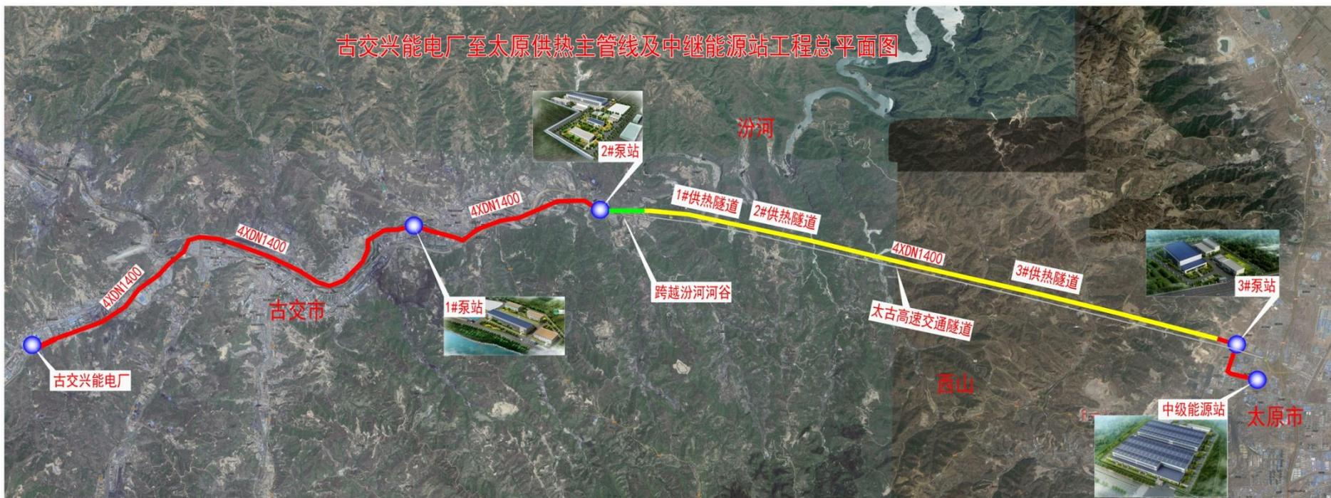
《古交兴能电厂至太原市供热主管道及中继能源站工程》是古交兴能电厂向太原市集中供热的主干线工程，建设4根DN1400供热管道（2套供热系统），总供热面积7600万平方米，输送高差180m，输送距离37.8km，其中供热隧道15.17km。工作压力2.5MPa，设计温度130/30℃。
