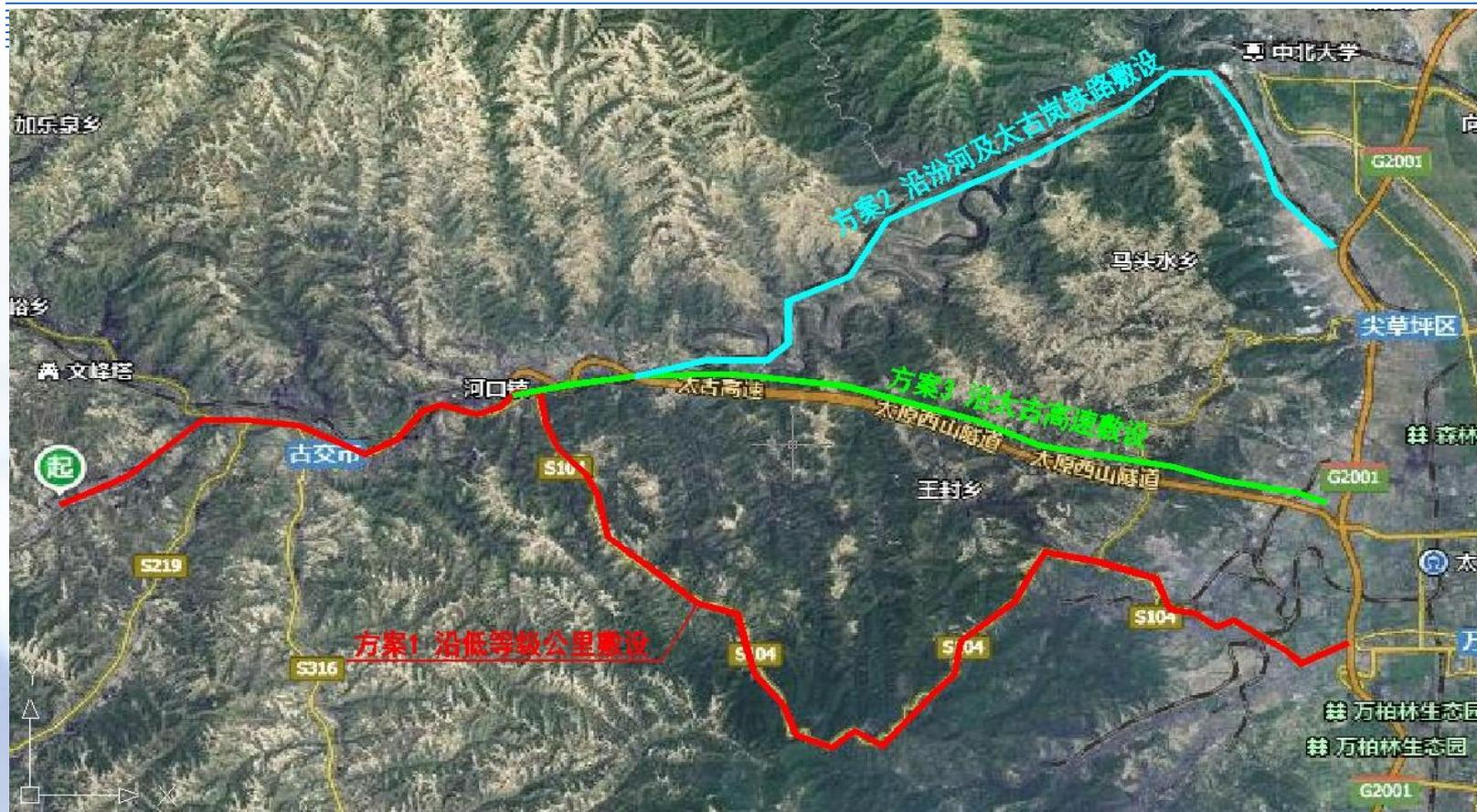
方案一：沿104公路敷设 方案二：沿汾河及太古岚铁路敷设 方案三：平行于太古高速公路隧道新建供热隧道敷设。可研阶段进行了经济技术比较，最终选择方案三，沿太古高速新建供热隧道敷设。
