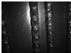
主油箱磁棒上的铁锈附着物
