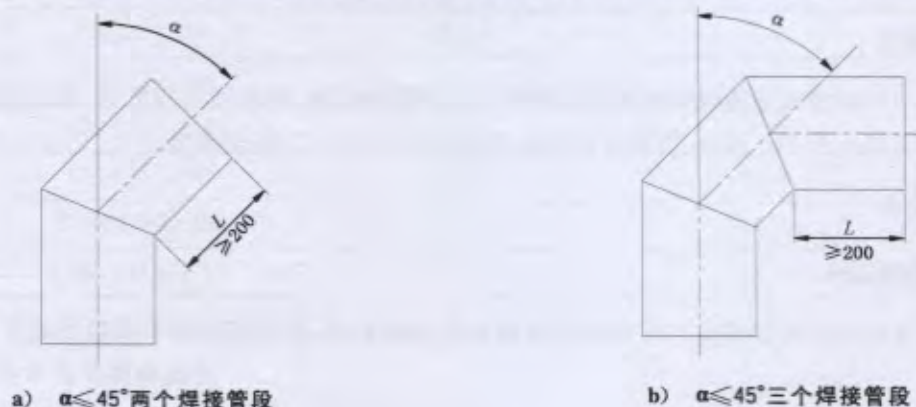
图 8 弯头与弯管外护管的相邻两个外护管段之间的最大角度
