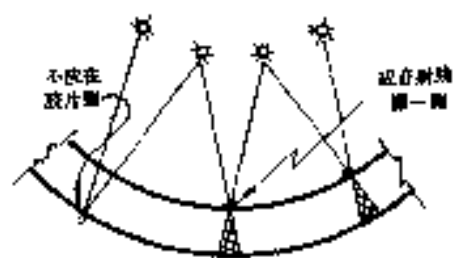
图 C2 射线源到底片距离小于 曲率半径的曲面部件
