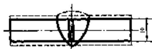
图 3 开在焊缝的缺口位置
