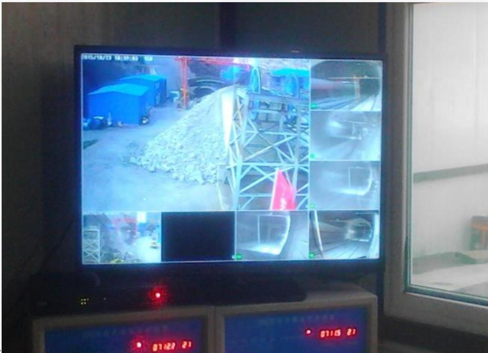
斜井底在施工范围的两侧安装2个摄像头，从不同方向监控斜井底的施工情况，洞口位置设置1个监控摄像头，对洞口的施工情况进行监控。卸渣台位置设置1个监控摄像头，用于监控这个卸渣的施工过程。
