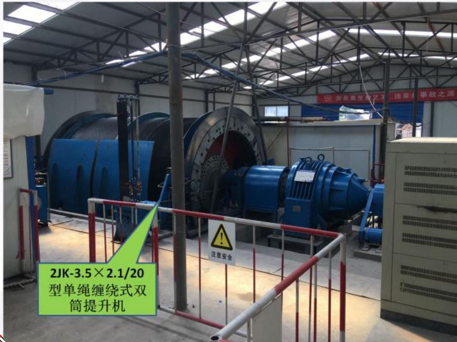
陡坡斜井提升运输设备选型需多方面进行综合考虑，首先根据施工工期确定每日的施工进度以及井底临时存渣场地存储能力，从而确定每日的最大出渣量。其次根据设计坡度要求，按照规范不大于5m/s提升速度要求、每日提升运行时间，计算出每小时提升量；每次提升重量；同时根据实际静张力差的结果初步选定设备型号。
