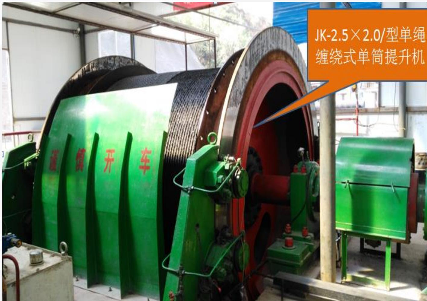
然后根据选定的设备型号、设计坡度、长度要求，计算所需钢丝绳的直径、钢丝绳的缠绕容量(即长度)、电机功率大小的配置、矿车容量及重量的配置。最后根据计算出所选择的设备配置，根据《矿山安全规程》逐一对所选的钢丝绳直径、钢丝绳的实际静张力、电机等进行安全检算，满足规定的安全系数后，说明选定的设备满足施工生产要求。
