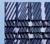
一般在预热器冷段使用涂搪瓷换热元件，将硫酸氢氨凝结区域和硫酸结露区域置于其内。防腐效果好，使用寿命长，成本相对较低。
