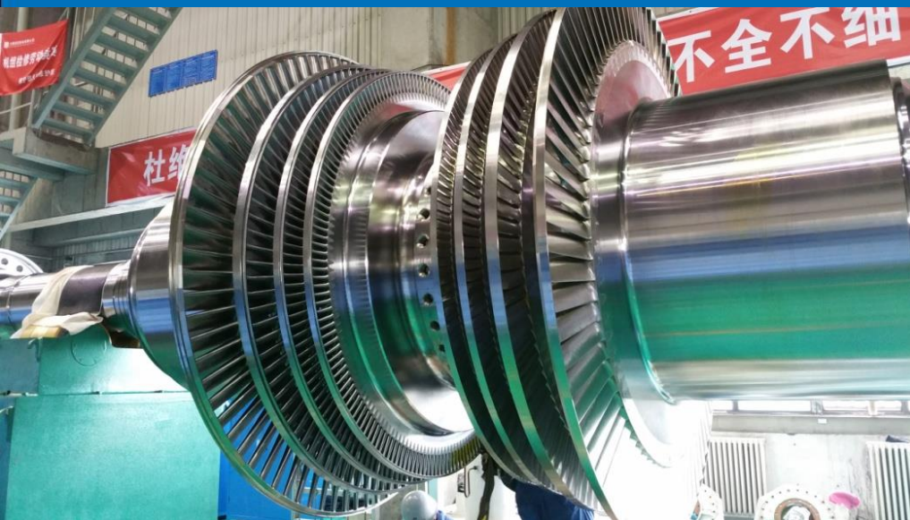
图2 新更换 2 \times 4 级转子
