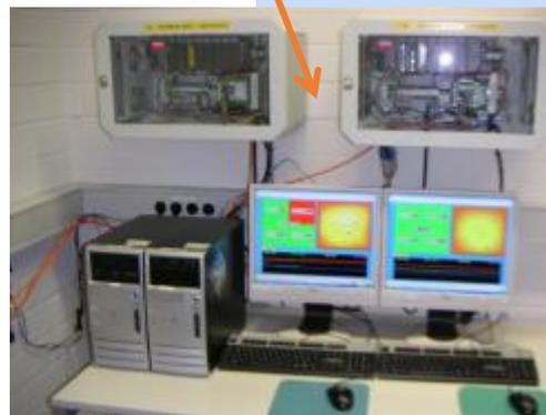
AGAM型声波法炉膛温度场测量系统是一类先进的在线二维温度场全工况实时监测设备，此设备是德国Bonnenberg+Drescher（简称B+D）公司多年的科技研究成果，可实现在各种工况下对锅炉、焚烧炉和各种加热炉内高温燃烧气体温度的实时连续的全自动测量。
