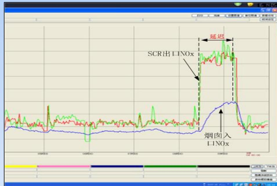
如图SCR出口NO<sub>x</sub>到烟囱入口的延迟时间将近4min（如图所示）。因此要控制烟囱入口的NO<sub>x</sub>，采用传统的方法将变得十分困难。
