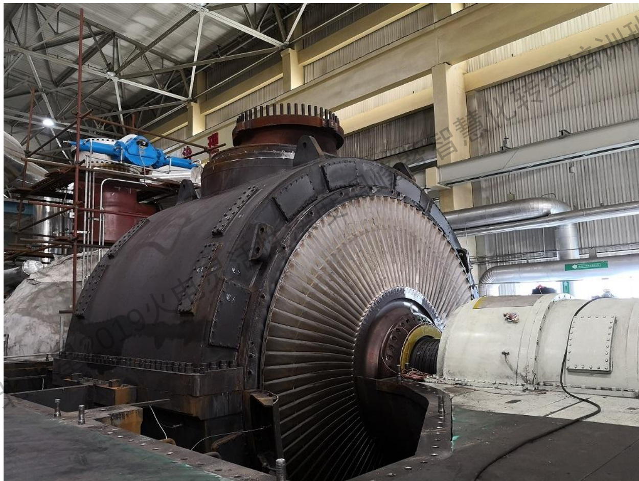
营口热电2号汽轮机末级叶片动应力试验现场
