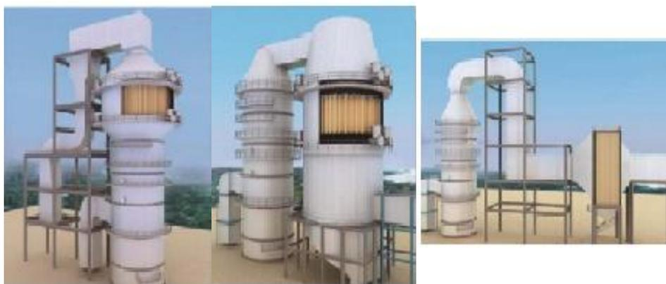
图 3 设备布置形式示意图（左：整体式；中：顺流式；右：错流式）
