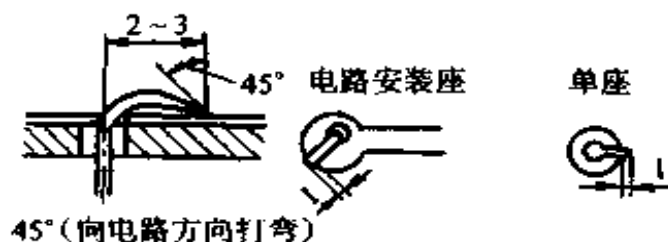
图 10-12 引线剪断长度和角度
