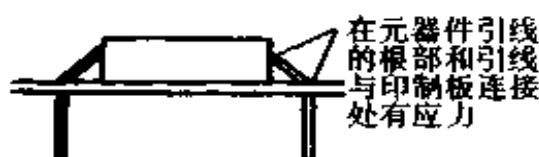
图 10-11 不正确的引线插装方法
