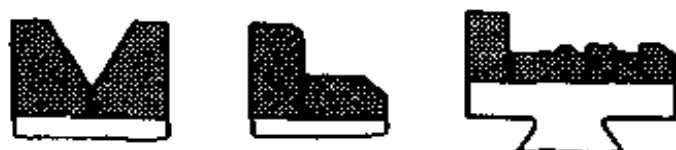
图 8-2 硬质合金较长时， 采用多块钎焊结构
