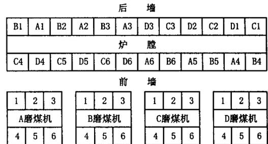
图1 4号锅炉磨煤机和燃烧器布置
