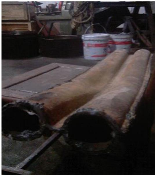
掉焦导致管子被砸炉内变形
