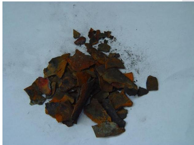
爆口处管子表面腐蚀产物
