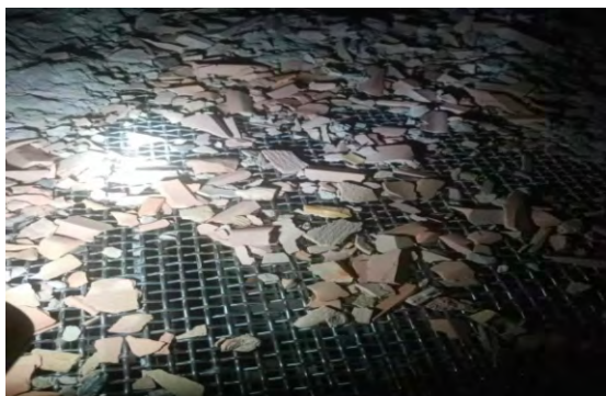
图1 大颗粒异物堵塞催化剂防护网
