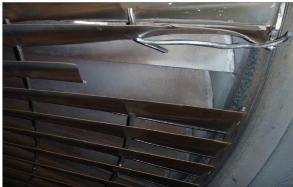
LMZ机组断裂的末叶片
